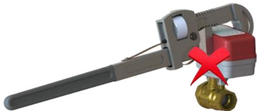
2): 禁止将两个扳手分别在管路两侧进行拧紧, 阀门双向受力, 有损坏的风险!
